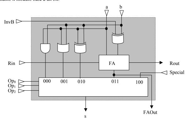
Il multiplexer è in grado di selezionare fino ad 8 ingressi; in questo caso le configurazioni 101,110,111 sono inutilizzate. La configurazione 100 permette ora di mandare verso l'uscita l'ingresso *Special* generato esternamente al modulo. Poiché ci occorre il segno del risultato della sottrazione per valutere la comparazione, aggiungiamo un'uscita FAOut per il risultato del FA, indipendente dalla selezione multiplexer.
