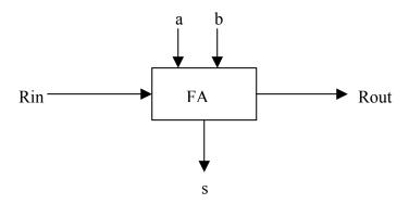
Aggiungendo un segnale di controllo ed un invertitore possiamo ottenere un l'inversione del bit b, utile per ralizzare un somma/sottrattore:
