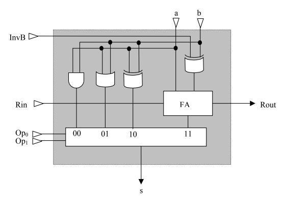
Il modulo così ottenuto è in grado di computare una serie di operazioni sui due bit in ingresso a e b in parallelo. Il risultato in uscita viene selezionato in base ai selettori del multiplexer  $Op_1Op_0$ . La funzione computata è mostrata dalla seguente tabella:
