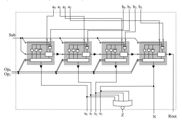
L'uscita N vale 0 quando il risultato e' positivo (>=0), 1 se negativo. Se impostiamo la sottrazione otteniamo su N il valore 1 se A<B, 0 se A>=B.
